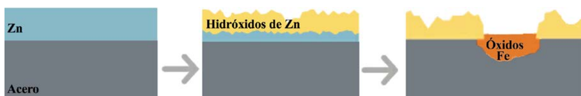
Figura 11. Esquema de proceso de pérdida de la capa de Zn y ataque sobre del acero
