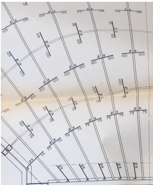
Figura 3. Planos de proyecto. Armadura de negativos en cubierta de sala (EL+23.30) y en la caja escénica (EL+27.20)
